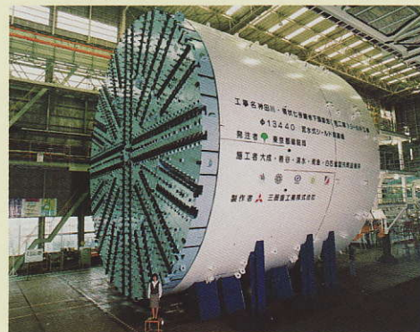
泥水式シールドマシン(第二期事業)
